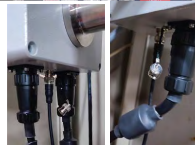
Connection cable ตรวจสอบค่าแรงดัน Transmitter - Receiver
